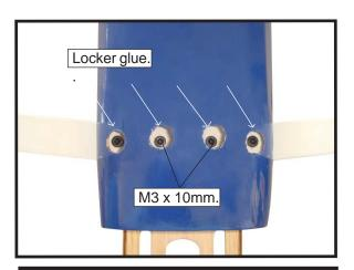
INSTALLING THE AILERON.
